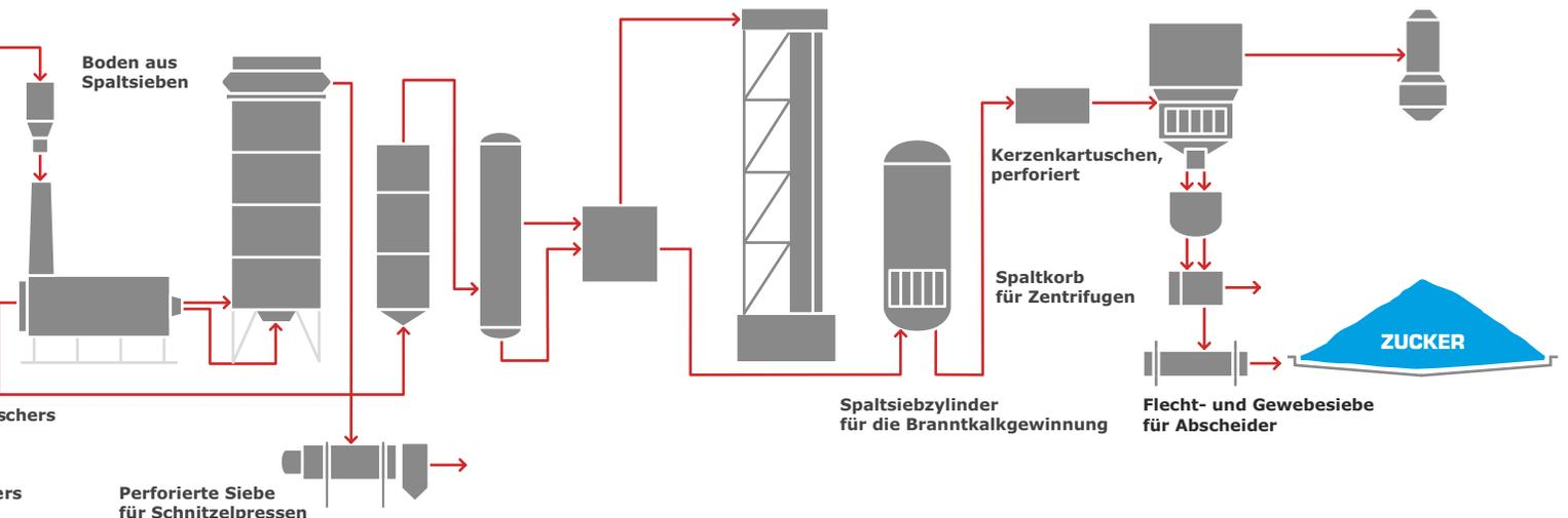
Pressen des Zuckerrübenschnitzel → Sisrupfiltration → Reinigung der Kalkmilch → Schleudern → Segregation → Reinigung des Schwemmwassers
