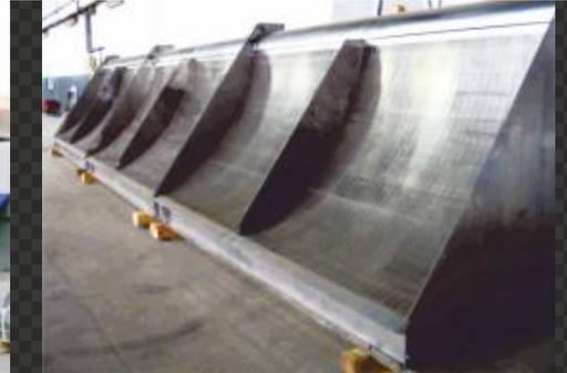
Spaltsiebkörbe werden in der Zuckerindustrie zum Abscheiden der Zuckerkrystalle vom Muttersirup des Magmas eingesetzt. Durch den Einsatz der modernen Korbkonstruktion können hohe Festigkeitskennwerte und eine entsprechende Leistung erzielt werden.
