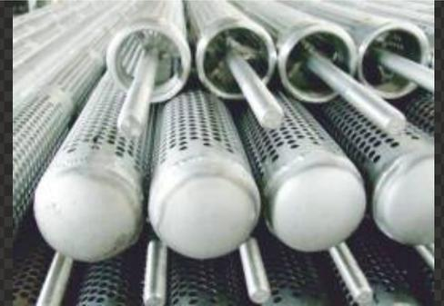
Lochsiebe finden beim Prozess der Spülung Anwendung, wo sie zur Trennung von festen Verunreinigungen aus dem Produktstrom dienen. Sie werden auch als Entwässerungselement in Schnitzelpressen und Stellagen für die Gewebesäcke in den Kerzenfiltern genutzt.
