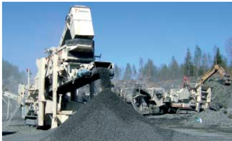
Dreistufiger Brech- und Siebprozess mit Lokotrack LT110, LT300GP und LT300GPB.
