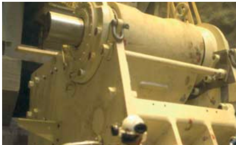
Ein Nordberg C200 bei der Installation in einem Bergwerk. Der Brecher wurde in Einzelteilen unter Tage transportiert und dort zusammengebaut.
