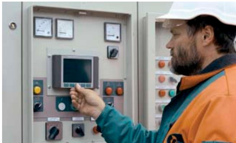
IC50 Automation in einem Lokotrack Mobilbrecher.
