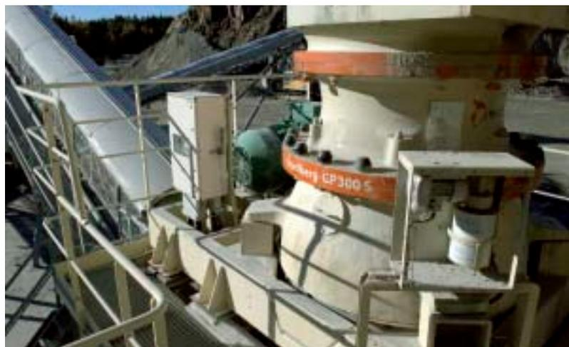
*Beispiel für einen GP300S in einer stationären Anlage.*
