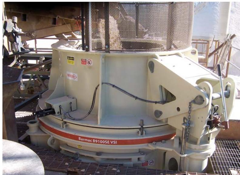
Der Kontrollschieber, der den Kaskadenprozentsatz beeinflusst, kann entweder manuell oder automatisch eingestellt werden.
