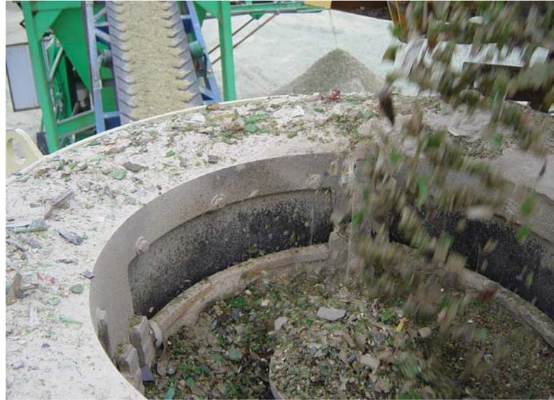
Glas kann mit dem Barmac VSI der B-Serie zerkleinert und recycelt werden.
