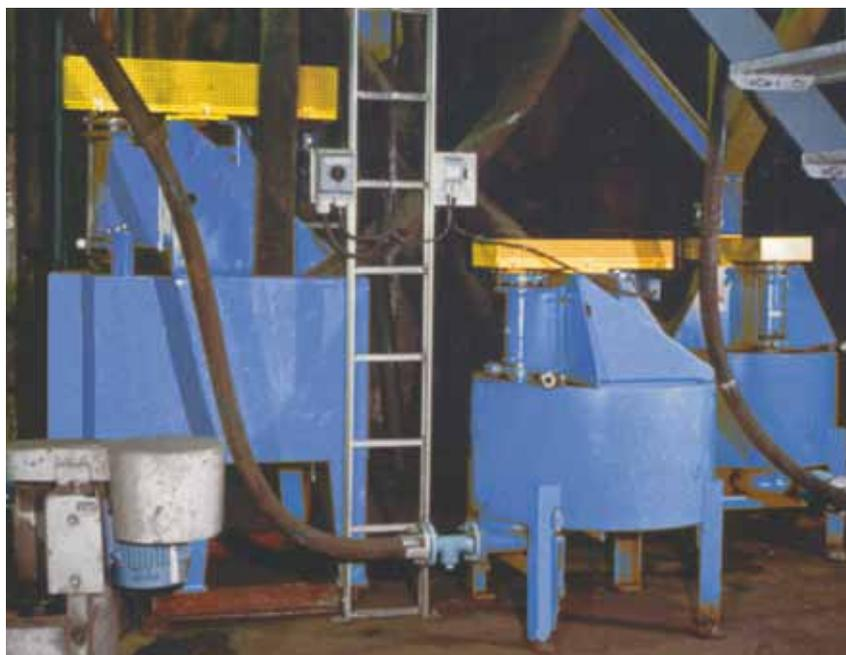
Metso VT Pumpen zum Pumpen von Konzentrat, Zwischengut und Haldenabfall von Spiralen zur Bearbeitung von Schlacken <2 mm.
