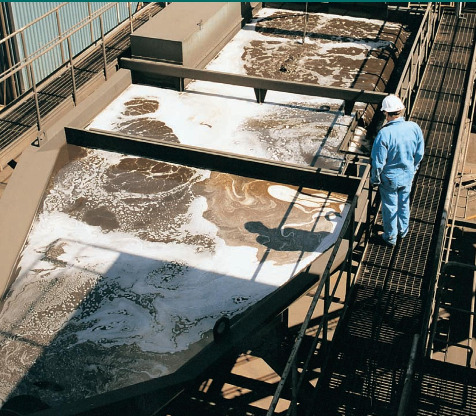
*Trübeverteiler in einer SD60-200-Anlage*
