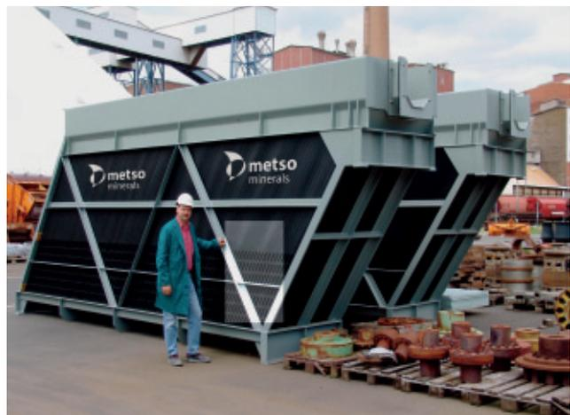
*Bild 5: Zwei Lamellen-Module mit je 200 m<sup>2</sup> Klärfläche
