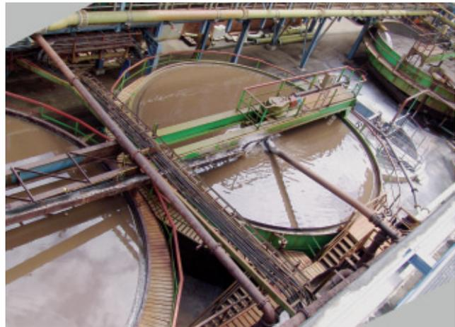
*Bild 4: Alte Rundeindicker-Anlage im Werk Unterbreizbach
