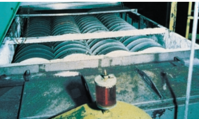
Die einzigartigen ineinandergreifenden Holo-Flite Schnecken eignen sich hervorragend für eine Vielzahl von schwierigen Trockenanwendungen.
