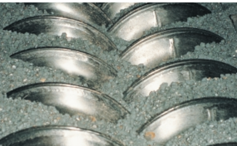
Der Holo-Flite® Prozessor wird zum Kühlen von Natriumtripolyphosphat in einem Chemiewerk verwendet.
