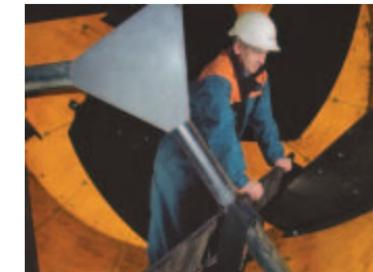
Freifallmischer mit unseren austauschbaren Gummi- oder PU-Auskleidungen.
