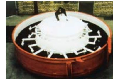
Komplettauskleidung eines Zwangsmischer mit Armschützern.
