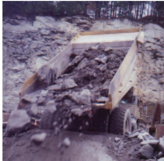
Mit verschleißfesten Trellex-Elementen, Typ PP, ausgekleideter Muldenkipper.
