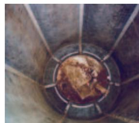
Komplettauskleidung mit Trellex Granuflex.
