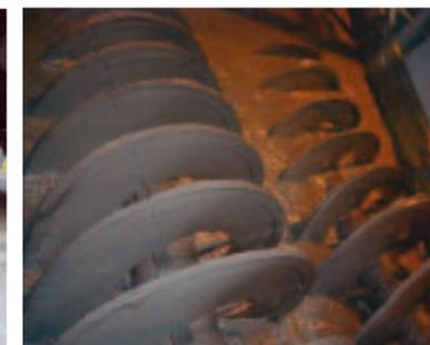
Klassierer mit Trellex Verschleißschutz Modul/Schuh ausgestattet.
