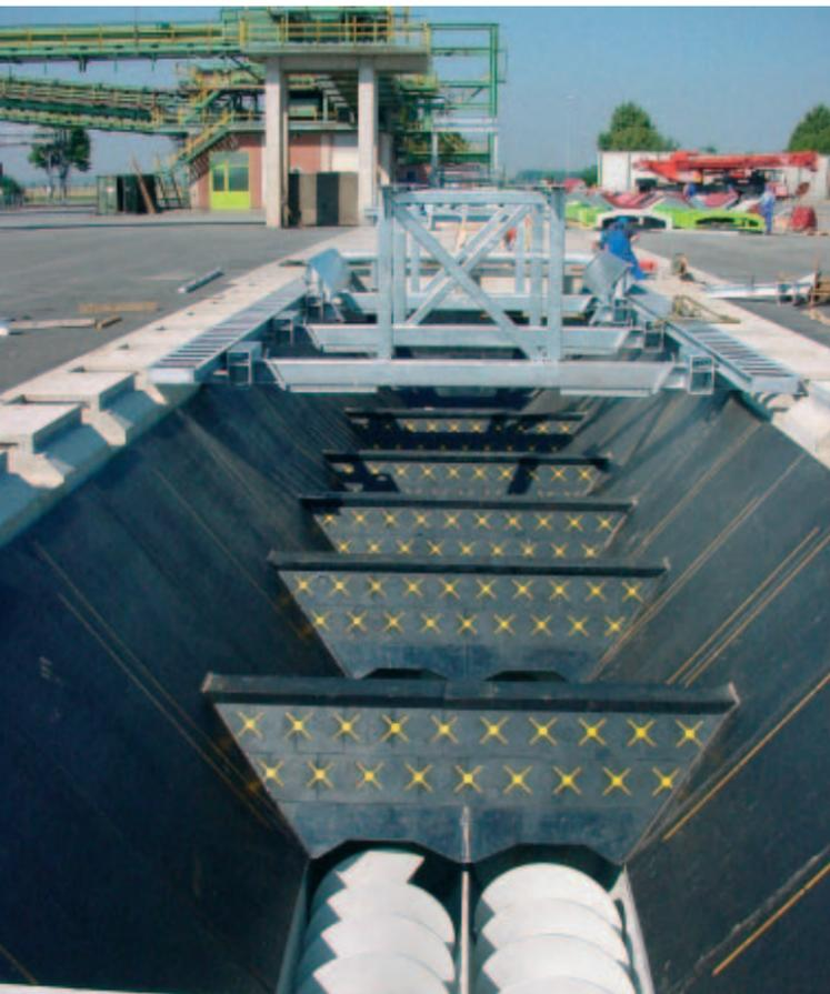
Aufgabeschuppe in einer Zuckerraffinerie mit Trellex SQ Modulen und PP-XL Verschleißschutzplatten ausgekleidet.
