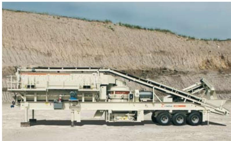
*Mobiler Einsatz: Die radmobile Brechereinheit Nordberg NW300HP mit integrierter Siebmaschine zerkleinert das Aufgabematerial im geschlossenen Kreislauf und sibt es in drei Endproduktfraktionen.*
