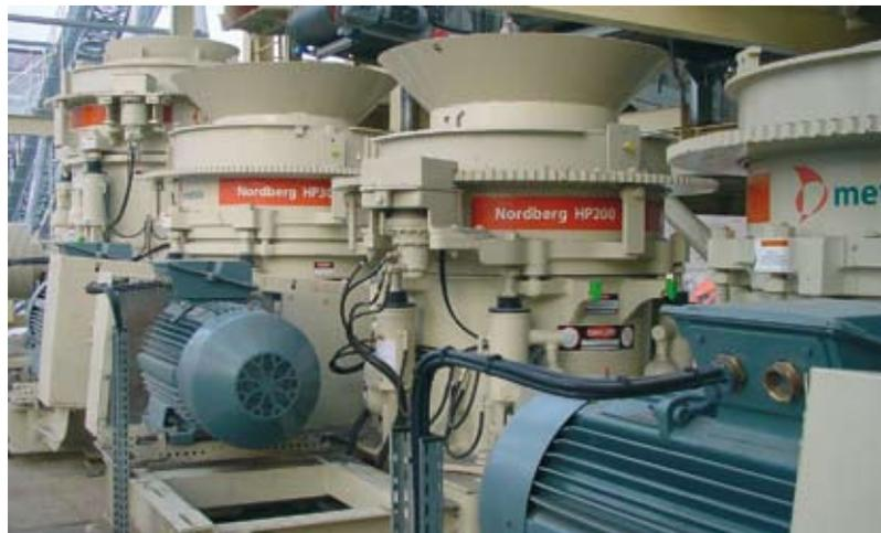
*Stationäre Anlage : ein HP500, ein HP300, zwei HP200.*
